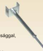
Gerincleártartó állítható magassággal, beütőcsavarral, 30 mm Szár: 75, beütő 250 mm. Szükséglet: 1 db / 0,7 fm gerinc
