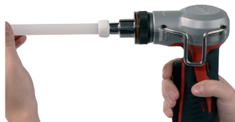
2. Tágítsa fel a csővéget a tágító szerszámmal
