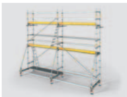
PERI UP vasszerelő állvány Moduláris felépítéssel, 10,80 m magasságig, kikötések nélkül
