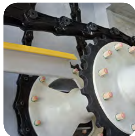
Tengely és fogaskerék üvegszál erősítésű műanyagból
