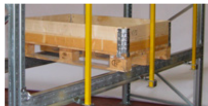
Függőleges túltolásgátló Megakadályozza a raklapok leesését az állvány hátoldalán.
