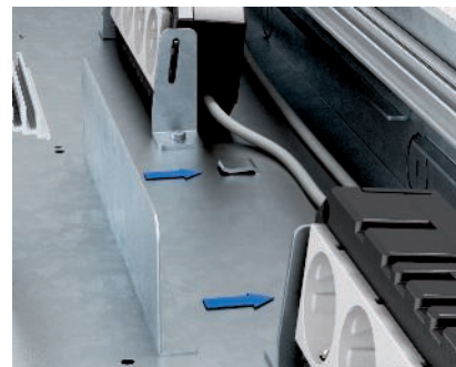
Válaszfalak szerelése A válaszfalakat csak a készre huzalozott szerelvények helyek és modul tartók beszerelése után helyezze be.
