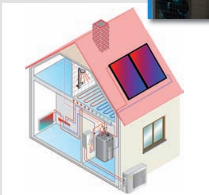
Hőszivattyú + szolár rendszer
