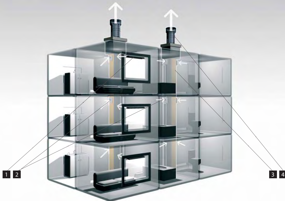
1. Légbefúvókák 2. Légbefúvókák 3. Légszűrők 4. Huzatfokozó ventilátor
